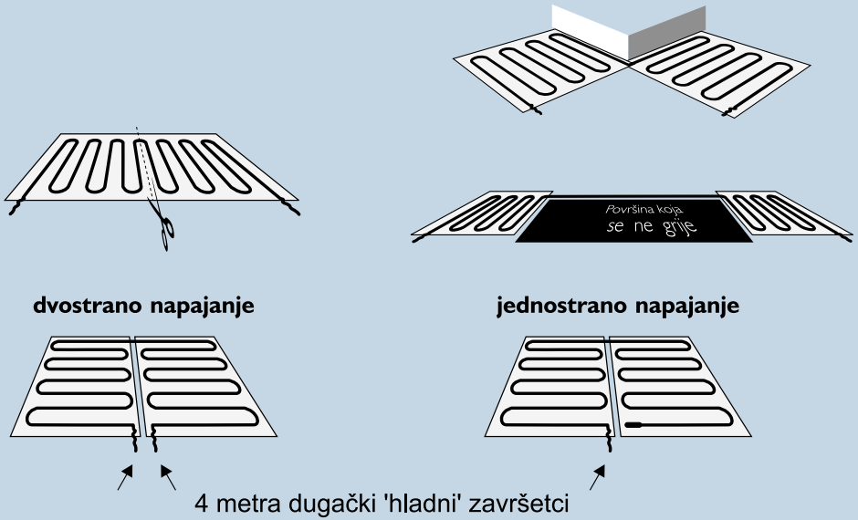
Slika 3. Primjeri postavljanja podnih električnih grijaćih mreža
