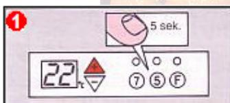
Startajte PROGRAM 5 u trenutku kada želite da Vam radijator počne raditi na sniženoj temperaturi od 15°C tijekom 5 sati (namješteno u tvornici). Pritisnite **5** i držite tako najmanje 5 sekundi, pokazivač će pokazati 15°C. Radijator je tako programiran na program 5. Kad radijator radi u režimu snižene temperature, treperi zelena lampica povše tipke **5**. Kad lampica stalno svijetli, znači da je radijator programiran na sniženu temperaturu ali da trenutno radi izvan tog režima.
