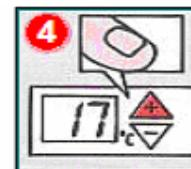
pritiskajući **+** ili **-** namjestite željenu sniženu temperaturu te pritisnite tipku **F**
