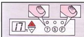
Ukoliko želite preskok (preskočiti preko perioda sa sniženim temperaturom), pritisnite **F** i držite pritisnuto dok istovremeno ne pritisnete **⑤** ili **⑦** (zelena lampica će tada svjetliti konstantnom svjetlošću).
