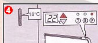
Namještena temperatura je  $22^{\circ}\text{C}$ . Upaljena crvena lampica ukazuje da je temperatura prostorije niža od željene.
