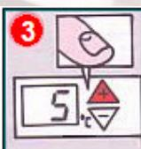
pritiskajući **+** ili **-** namjestite željeni broj sati rada u režimu snižene temperature, te pritisnite tipku **F**.
