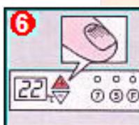
Pritisakajući **+** ili **-** namjestite na pokazivaču temperaturu koju pokazuje termometar na zidu. Završite pritiskom na **F**, i ponovo namjestite željenu temperaturu radijatora. Nakon nekog vremena kad radijator postigne stabilan rad, termometar i radijator će pokazivati istu temperaturu
