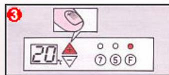
Namjestite željenu temperaturu (npr.  $22^{\circ}\text{C}$ ) Pritisakajući **+** ili **-**.
